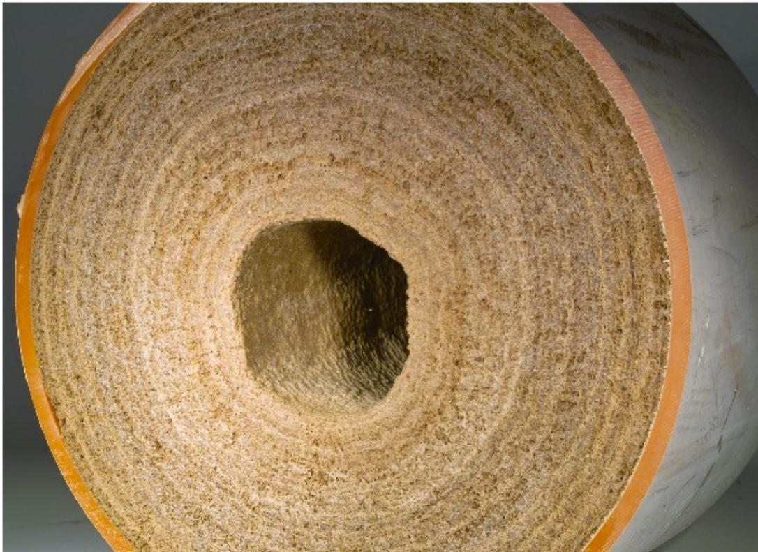
Die Wasserleitung aus Kunststoff stammt aus Lengfurt, wo sie infolge eines hohen Gehalts an Ca-Ionen in nur etwa 20 Jahren bis auf einen geringen Restquerschnitt mit Calcit ( $\text{CaCO}_3$ ) verschlossen wurde.
